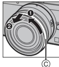
1 Drehen Sie den Dekorationsring (C) in Pfeilrichtung, um ihn zu entfernen.
